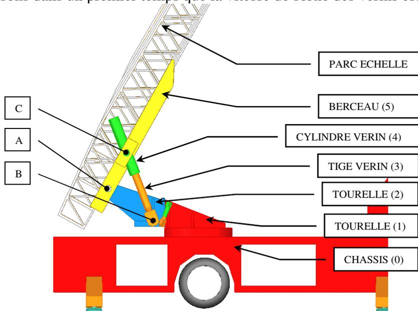
Pendant la phase de dressage, les tourelles 1 et 2 sont fixes par rapport au châssis du camion ; seul le berceau pivote autour de l'axe A, entraînant avec lui le parc échelle et la plate-forme. Ce mouvement est obtenu grâce aux vérins hydrauliques articulés en B et C avec la tourelle 2 et le berceau. Sur la figure du document réponse, l'angle de dressage est maximum.
