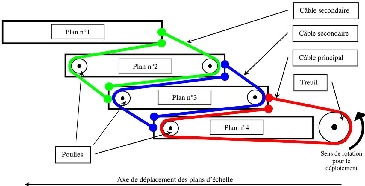
La figure précédente montre les plans du parc échelle les uns au dessus des autres ; en réalité, ils sont les uns dans les autres et tous les brins de câbles sont donc parallèles à l'axe de déplacement des plans d'échelle.
