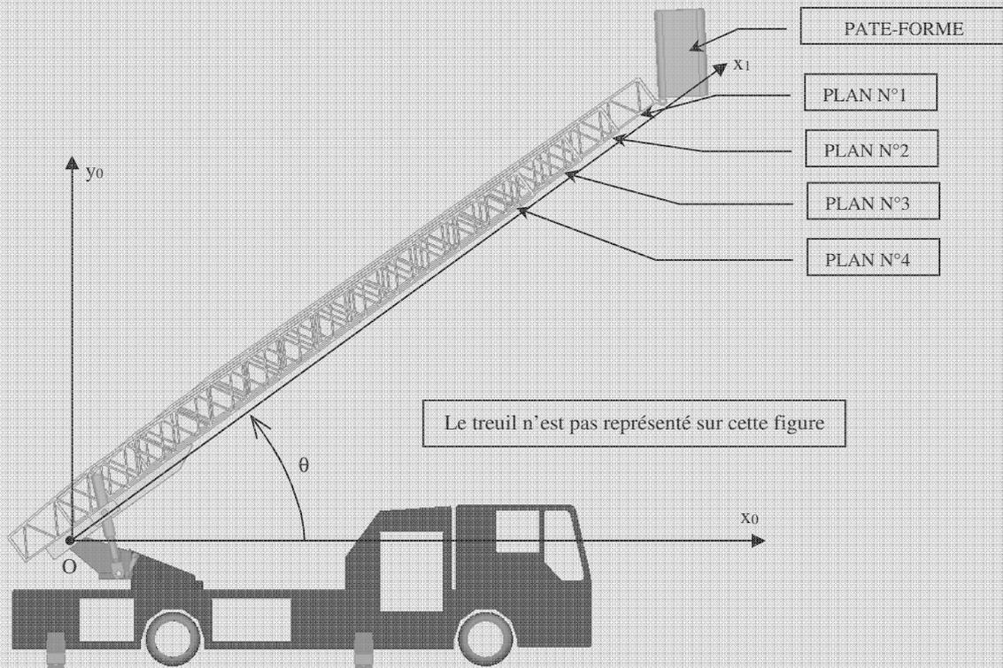
On note  $R_0 = (O, \bar{x}_0, \bar{y}_0, \bar{z}_0)$  le repère lié au châssis et  $R_1 = (O, \bar{x}_1, \bar{y}_1, \bar{z}_0)$  le repère lié au berceau.
