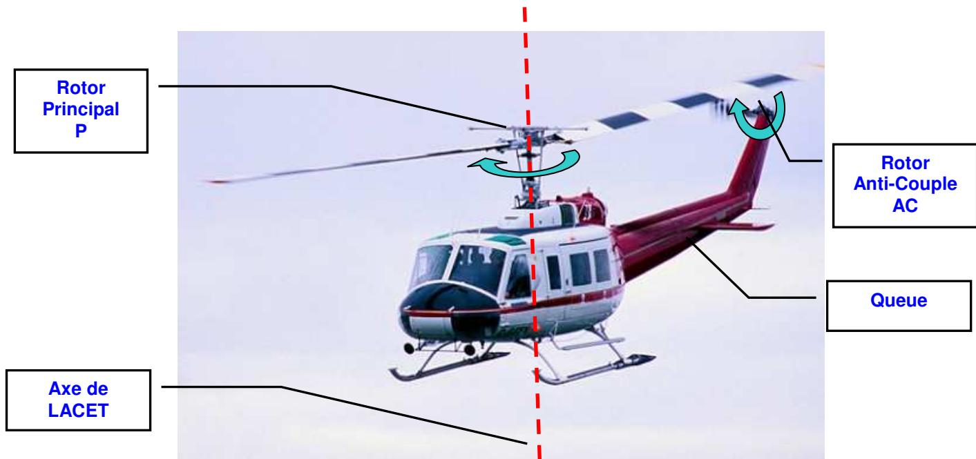
Le système ainsi constitué, à condition qu'il soit bien installé, n'est sensible qu'aux seuls mouvements de la machine autour de son axe de lacet; il agit quasi instantanément sur le rotor anti-couple pour que celui-ci applique un effort égal et opposé à celui généré accidentellement selon la chronologie ci-dessous:
