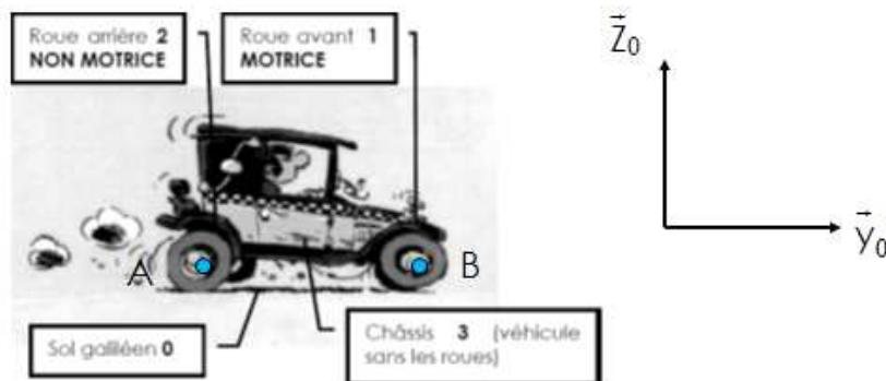
On suppose le RSG aux contacts sol / roue (nommés B' et A'), l'absence de frottement dans les liaisons (liaisons parfaites) et des contacts ponctuels aux contacts sol / roue (B' et A').
