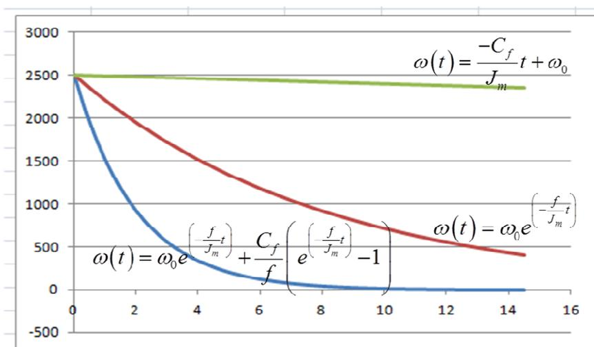
En  $t_2$ , frottement visqueux équivalent à frottement sec :  $-C_f = -f \cdot \omega(t)$
