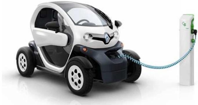
Logée sous le siège avant, la batterie, d'une capacité de 6,1 kWh (105Ah), se charge complètement en 3h30 sur une simple prise secteur via un câble d'une longueur de trois mètres.
