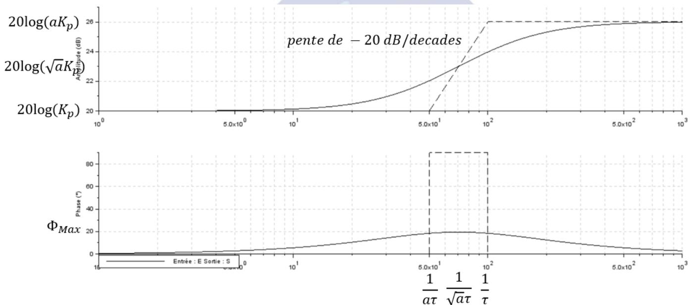
**Question 21** Déterminer la valeur de  $\Phi_{Max}$ , permettant de respecter la marge de phase sachant que la pulsation de coupure à 0dB souhaitée de la FTBO est de 10 rad/s. Décrire ensuite la démarche permettant de déterminer les valeurs de  $a$ ,  $\tau$  et  $K_p$ . Les applications numériques ne sont pas demandées.
