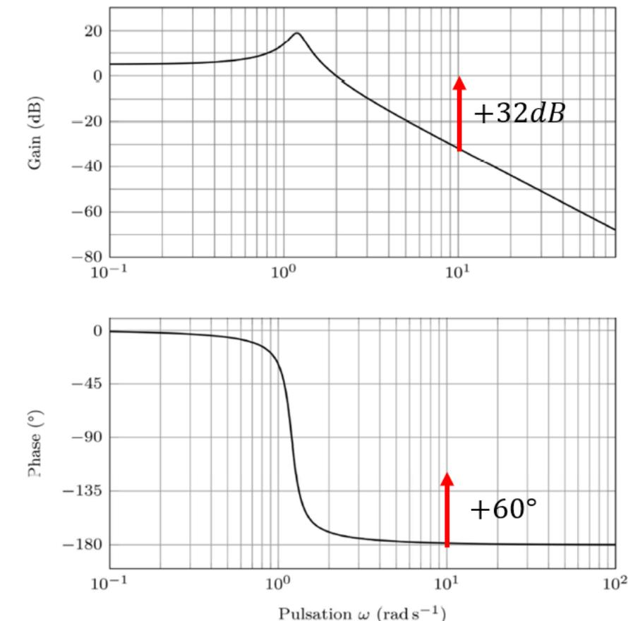
Pour respecter la marge de phase, il est nécessaire de monter la phase de  $\Phi_{Max} = 60^\circ$ . On en déduit ainsi la valeur de  $a$  :
