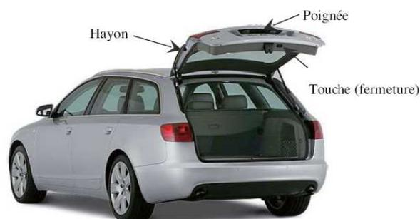
Photographie 1 - Audi A6 Avant avec coffre motorisé (source Audi).
