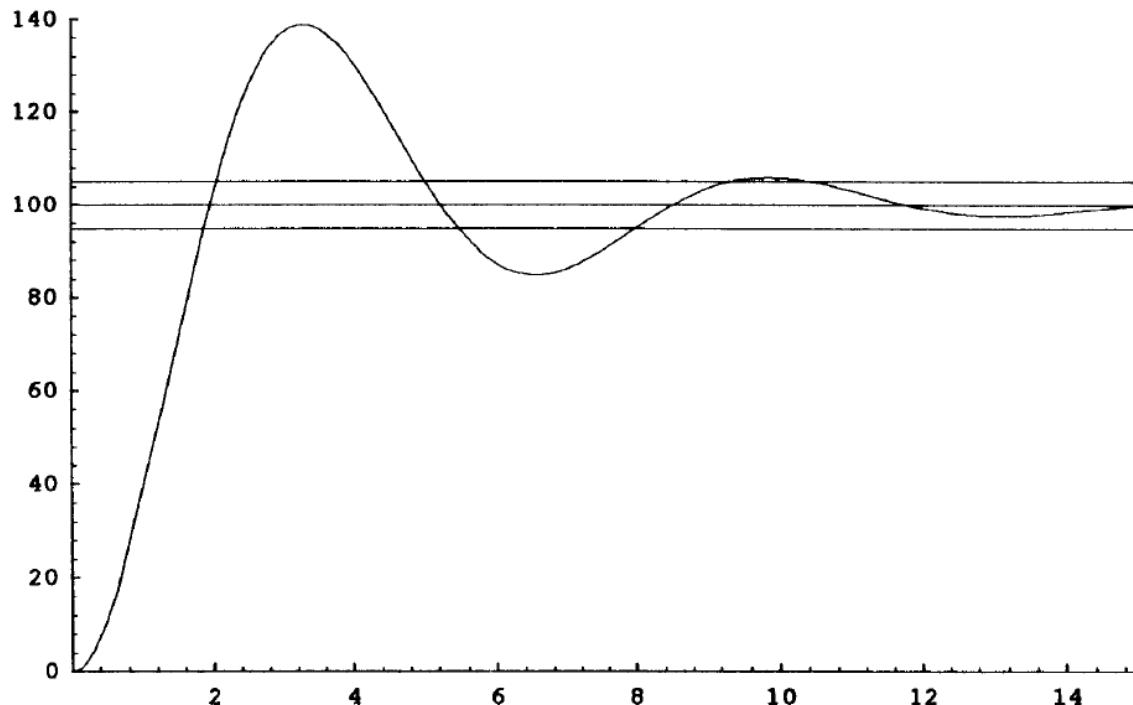
Si on trace la courbe représentant le produit (temps de réponse x  $\omega_n$ ) en fonction du coefficient d'amortissement  $\xi$  (voir figure page suivante) on obtient pour les deux valeurs extrêmes de la
