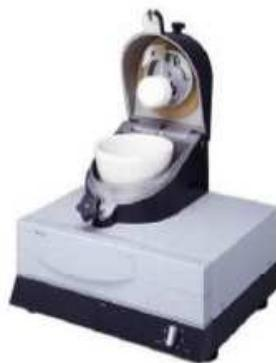
Pour réduire en poudre les matériaux, on utilise un mortier (pièce cylindrique) qui effectue un mouvement combiné de rotation et de translation, afin de broyer et d'écraser les agglomérats de matériaux.
