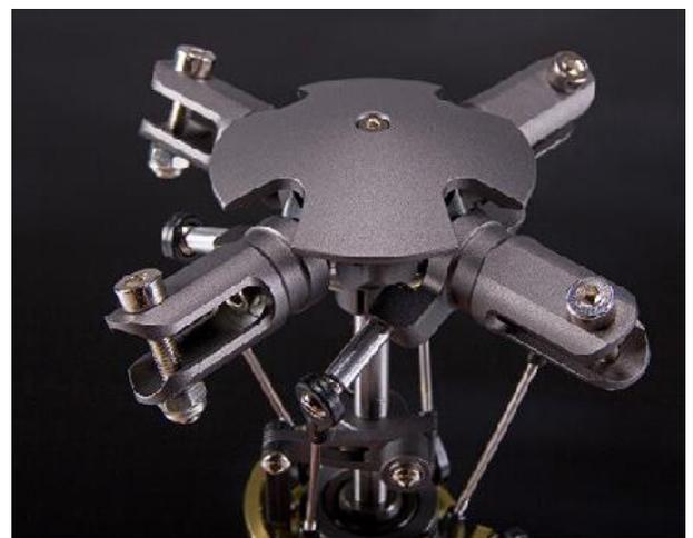
Le rotor d'un hélicoptère est composé principalement des pales et de la cellule de mise en mouvement de celles-ci (photos ci-dessus).
