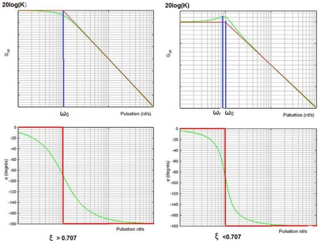
Le tracé de la phase est symétrique par rapport au point d'abscisse  $\omega_0$  et d'ordonnée  $-90^\circ$ .
