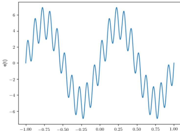
On fait passer ce signal dans un filtre passe-bas du premier ordre de fréquence de coupure  $f_0 = 2$  Hz.
