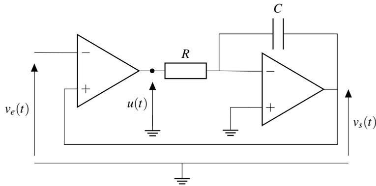
Le circuit est attaqué par une tension  $v_e(t)$  périodique de période  $T$  dont l'évolution est présentée ci-dessous. On donne  $E = 5\text{V}$  et  $T = 5 \text{ ms}$ . A l'instant initial, le condensateur n'est pas chargé. Les tensions de saturations des A.O sont  $\pm V_{\text{sat}} = \pm 13\text{V}$ .
