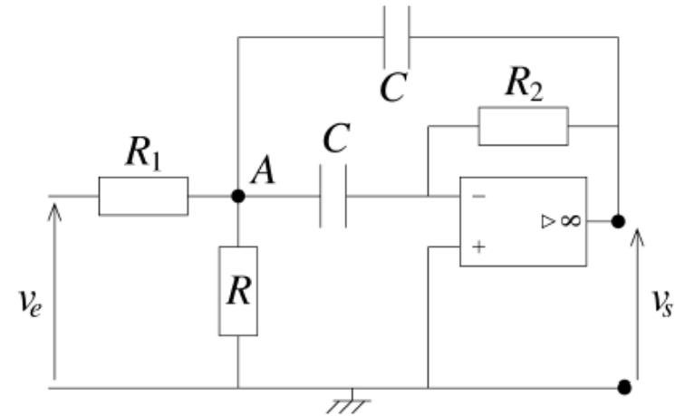
1. (a) Représenter les schémas équivalents à haute et basse fréquence et en déduire la nature du filtre.
