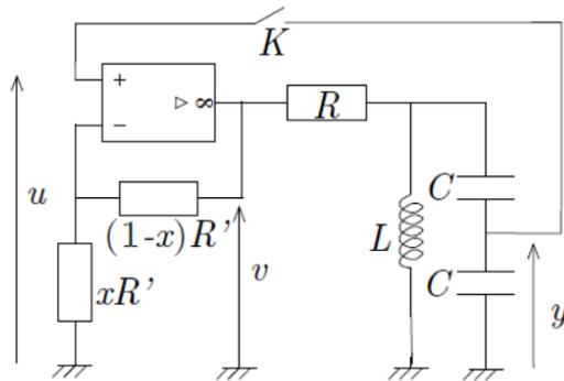
1. Lorsque l'interrupteur est ouvert, calculer en régime sinusoïdal de pulsation  $\omega$  la fonction de transfert  $\underline{H} = \frac{y}{u}$ . Montrer en particulier que  $\underline{H}$  peut s'écrire sous la forme :
