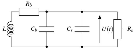
Justifier qu'on puisse remplacer les deux condensateurs par un condensateur équivalent  $C_{eq}$  dont on exprimera la valeur en fonction de  $C_b$  et de  $C_s$ .
