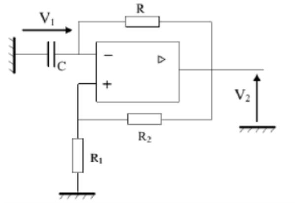
1. Identifier dans le montage ci-dessus le bloc intégrateur et le bloc comparateur à hystérésis.
