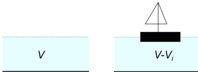
**Argument 1** Sans bateau, une longueur  $L$  de pont doit supporter un volume  $V$  d'eau, soit une masse  $\rho_e V$  d'eau. Avec bateau, le pont doit supporter une masse  $(V - V_i)\rho_e$  d'eau, où  $V_i$  est le volume immergé du bateau, plus la masse  $m$  du bateau. Le bateau étant en équilibre hydrostatique, on a  $m = \rho_e V_i$ . Le pont supporte donc toujours la même masse. Il n'y a pas plus de chance de s'effondrer lorsqu'un bateau passe.
