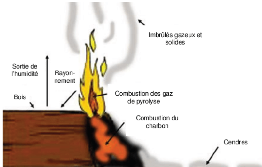
Figure 1 Différentes phases de combustion du bois 1
