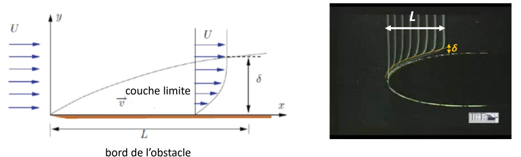
• La couche limite est due à la viscosité du fluide. En effet, celle-ci impose l'adhérence du fluide à la paroi de l'obstacle. En dehors de la couche limite, on peut considérer l'écoulement comme parfait (la viscosité ne joue plus aucun rôle).
