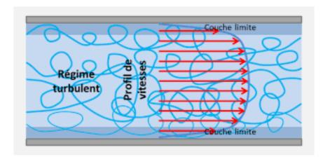
Le profil moyenné dans le cas turbulent est beaucoup plus régulier que le profil laminaire. La vitesse est quasiment uniforme sur une section droite du tube à part dans une zone très proche des parois appelée couche limite.
