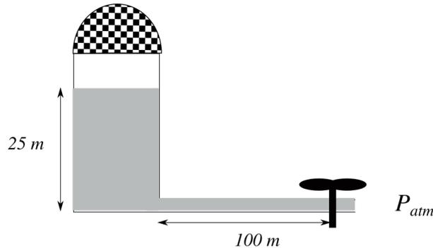
1. Quel est l'ordre de grandeur de la pression qui peut être attendue dans une canalisation au pied d'un château d'eau de 25 m de eau ? On supposera que le débit dans la canalisation est suffisamment faible pour ne pas perturber le champ de pression dans le château d'eau. On prendra  $g = 10 \text{ m}\cdot\text{s}^{-2}$ .
