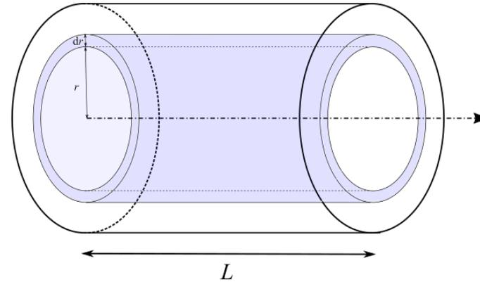
1. Question préliminaire : exprimer le volume  $dV$  d'une petite cerne cylindrique (cf. figure ci-dessus) et montrer qu'en sommant le volume de toutes les cernes comprises dans le cylindre, on retrouve le volume total du cylindre.
