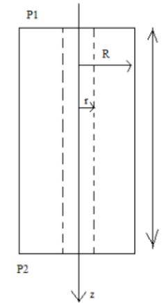
On s'intéresse à une portion de liquide contenue dans un cylindre de rayon  $r$  ( $r < R$ ), compris entre les plans de pressions  $P_1$  et  $P_2$  distants de  $L$ .
