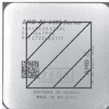
FIGURE 1 – Photographie d'une puce AMD A6-5400 et représentation de la surface utile  $S_u$  (carré hachuré)
