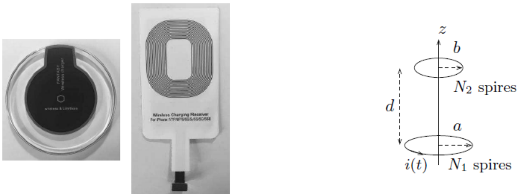
FIGURE 6 — À gauche : système de transmission classique (émetteur et récepteur) utilisé dans les chargeurs sans fil actuels. À droite : schéma et notations utilisés.
