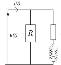
2. En mode froid, le sèche cheveu se réduit à la bobine réelle qui consomme une puissance  $P_{r-L} = P_F = 520\text{W}$ . En mode I et II, la puissance moyenne consommée par l'appareil vaut :
