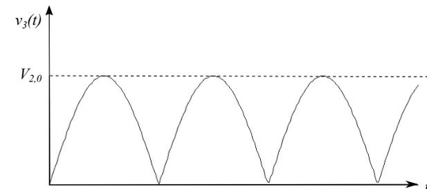
3. Un filtre moyennneur est un filtre passe-bas qui ne laisse passer que la valeur moyenne d'un signal. Il faut donc que sa fréquence de coupure soit inférieure à la fréquence de la fondamentale de  $v_3(t)$ , qui est égale à la fréquence du signal lui-même. Le signal en sortie du redresseur ayant une fréquence  $f = 2f_0 = 100\text{Hz}$ , on pourra prendre  $f_c = 10\text{Hz}$ .
