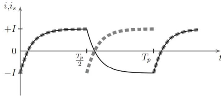
9. Le courant  $i(t)$  changeant de signe sur chaque intervalle, il nous faut des interrupteurs pouvant faire passer le courant dans les deux sens. C'est pourquoi on a besoin d'une association transistor-diode tête-bèche.
