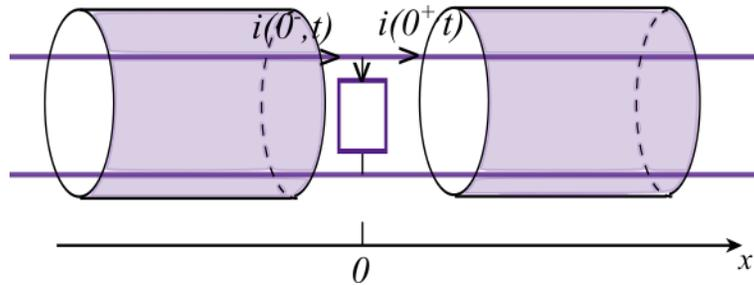
Notons  $i(0^-, t)$  le courant traversant le câble en  $x = 0^-$ ,  $i_z(t)$  le courant traversant l'impédance  $Z_1$  et  $i(0^+, t)$  le courant traversant le câble en  $x = 0^+$ . On a :
