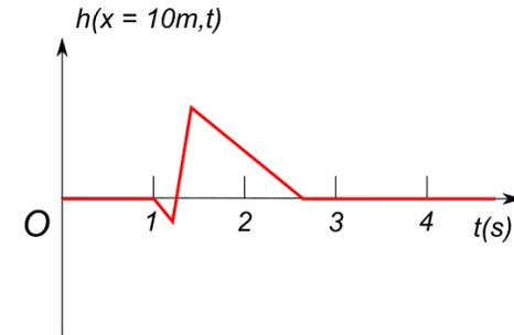
Notez que l'abscisse désigne maintenant le temps : on se place à une position  $x_0$  fixe et on mesure la hauteur d'eau avec un chronomètre.
