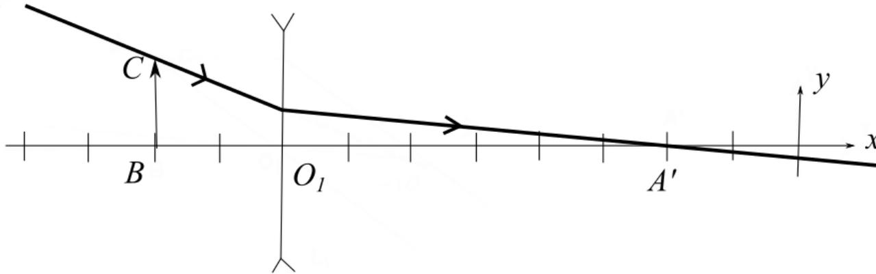
En s'appuyant sur la construction graphique du rayon émergent croisant l'axe optique en  $A'$ , déterminer  $f'_1$ .
