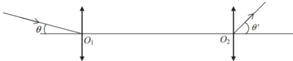
Déterminer l'expression du grossissement de la lunette  $G = \frac{\theta'}{\theta}$  en fonction de  $f'_1$  et  $f'_2$ , et calculer ce grossissement si  $f'_1 = 1,0$  m et  $f'_2 = 20$  mm.
