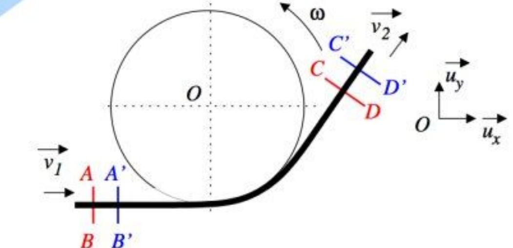
Dans le référentiel terrestre, l'eau arrivant **en entrée** à la **vitesse  $\vec{v}_1$**  frappe le rotor (constitué d'aubes) qui la défléchit, et l'eau possède finalement une **vitesse de sortie  $\vec{v}_2$** . On note  $D_m$  le **débit massique** du jet d'eau. Les vitesses d'entrée et de sortie sont connues.
