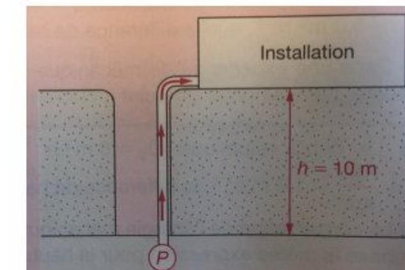
→ Estimer le travail indiqué nécessaire, et donner sa valeur  $\text{J} \cdot \text{kg}^{-1}$ . En déduire la puissance nécessaire de la pompe  $P_i$ .
