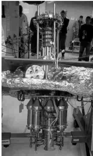
Figure 2 Système de test KRUSTY positionné tête en bas dans une chambre à vide : moteurs Stirling en bas et cœur d'uranium en haut (NASA)
