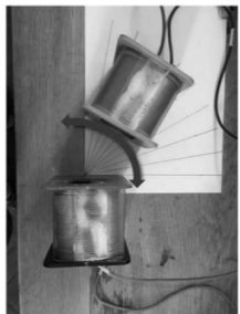
FIGURE 11 – Évolution du rendement en fonction de l'angle entre les bobines.
