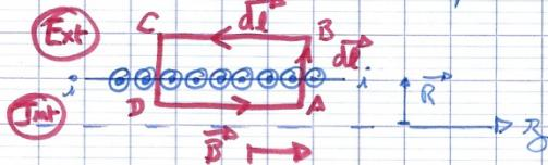
$$\oint_C \vec{B} \cdot d\vec{L} = \int_{AB} \vec{B} \cdot d\vec{L} + \int_{CD} \vec{B} \cdot d\vec{L} + \int_{BC} \vec{B} \cdot d\vec{L} + \int_{DA} \vec{B} \cdot d\vec{L}$$
