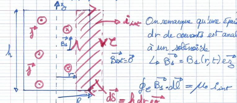
$$\oint \vec{B}_1 \cdot d\vec{l} = \int B_1(r, t) e_z \cdot dl e_z = \int B_1(r, t) dl = B_1(r, t) h$$
