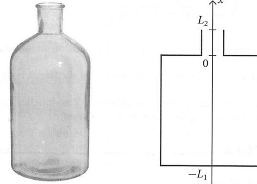
On cherche les pulsations  $\omega$  des modes propres de la bouteille décrits par les champs de vitesses dans le corps :
