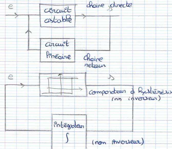
Il chaîne directe  $\rightarrow$  en Bc<sup>t</sup> non-Pénéoline avec saturat° de PALI ds la pratique  $s = \pm i\omega_t \rightarrow$  oscillat° pr 2 état° sans stabilisat°  $\rightarrow$  oscillateur instable
