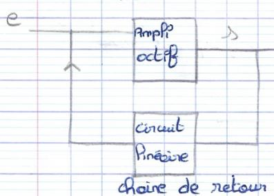
1<sup>o</sup> Principe et structure d'un oscillateur à boucle de rétroact<sup>o</sup>, exple de l'oscillateur à pont de Wien
