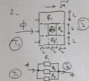
On décompose la brique en 3 résistances R<sub>1</sub>, R<sub>2</sub>, R<sub>3</sub> ( $\Delta$  brique carree)
