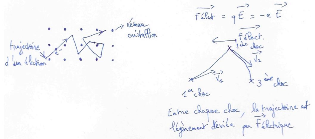
Pour donner une explication microscopique du terme de frottement, Drude a considéré que les **électrons** subissent des **collisions avec les ions métalliques fixes** du réseau. Ces **chocs** sont supposés **instantanés**, **après chaque choc**, la **direction** et la **norme de la vitesse** d'un électron sont **aléatoires**. Entre deux chocs, un électron n'est soumis qu'à l'action du champ électrique.
