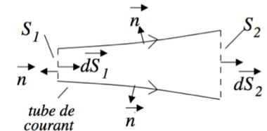
Ainsi l'intensité du courant est indépendante de la section choisie dans un tube de courant donné. Cette propriété joue un rôle essentiel dans les circuits électriques. Les fils électriques sont bornés par un matériau isolant et constituent naturellement des tubes de courant électrique.
