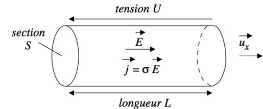
On considère une portion de conducteur cylindrique d'axe  $Ox$ , de section  $S$  et de longueur  $L$ , baignant dans un champ électrique uniforme et stationnaire  $\vec{E} = E_0 \vec{e}_x$ . En pratique, un générateur extérieur applique une tension aux extrémités du matériau et produit ce champ.
