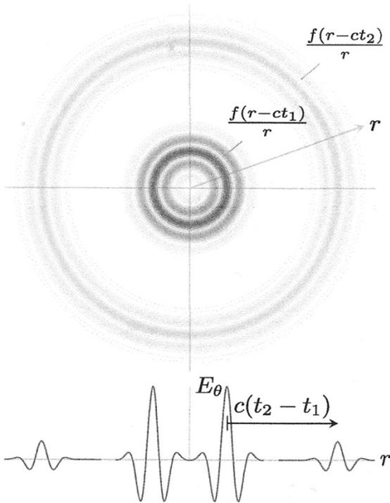
La surface d'onde a pour équation  $r - ct = \text{cste}$  ce qui correspond à une onde se dilatant à la vitesse  $c$
