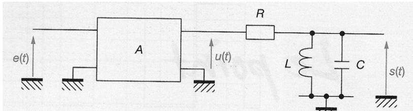
Le bloc désigné par A réalise la fonction amplification  $u(t) = K e(t)$  où K est une constante, dans la plage de fonctionnement envisagée dans un premier temps.
