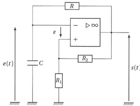
Aucun générateur n'est utilisé ici, et on observe les oscillations de relaxation du montage à l'aide d'un oscilloscope, qui mesure les tensions d'entrée et de sortie étudiées  $e(t)$  et  $s(t)$ . L'ALI est supposé idéal. On note les tensions de saturation de l'ALI  $\pm V_{SAT}$ . On posera  $k = R_1/(R_1+R_2) < 1$  (et  $> 0$ ) et  $\tau = RC$ .
