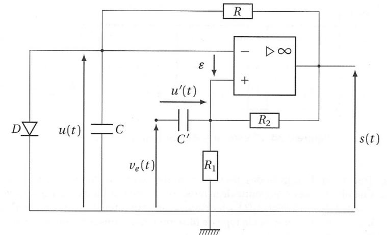
Figure 4.31. Montage multivibrateur monostable.
