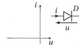
Figure 4.32. Caractéristique d'une diode idéale.
