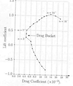
Figure 5 - Polaire de l'aile NACA 66-415
