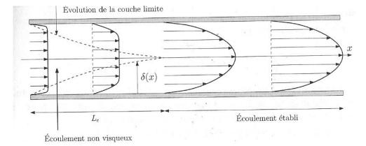
Expérimentalement, on mesure  $L_e$  / D  $\approx$  0,06  $R_e$ . En exploitant le temps caractéristique de diffusion par viscosité appliqué à la couche limite et le temps caractéristique de convection trouver une relation équivalente entre  $L_e$ ,  $R_e$  et D.
