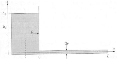
On mesure la durée de descente  $\Delta t$  du fluide entre deux niveaux d'altitude  $h_1$  et  $h_2$ . On rappelle la loi de Hagen-Poiseuille applicable pour un écoulement laminaire dans une conduite de longueur L, qui relie le débit volumique à la différence de pression entrée/sortie :  $D_V = \frac{\pi r^4}{8\eta} \frac{\Delta P}{L} = \frac{\Delta P}{R_{cavillaire}}$
