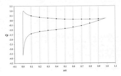
Figure 7 - Coefficients de pression sur intrados et extrados
