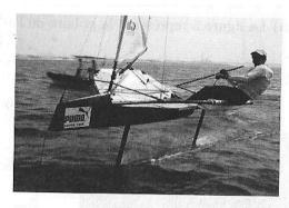
Figure 1 - Exemple d'hydrofoils : le Moth
