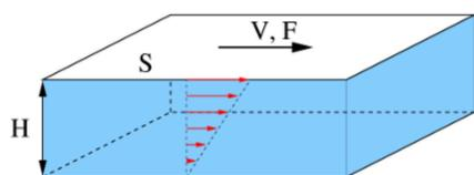
Le palet mobile met en mouvement la couche supérieure de fluide à sa surface, qui entraîne à son tour une couche inférieure, ce **transfert de quantité de mouvement** (déplacement) des couches de fluide se répète de proche en proche sur chaque couche de fluide, jusqu'à atteindre le fond du cristalliseur. On peut faire **l'analogie avec les cartes d'un jeu lorsque l'on pousse la carte supérieure**.
