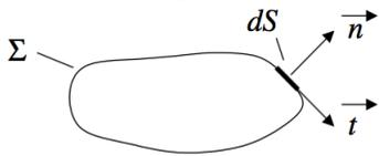
La **résultante des forces exercées par l'extérieur** sur l'élément de surface dS peut être décomposée en deux termes :
