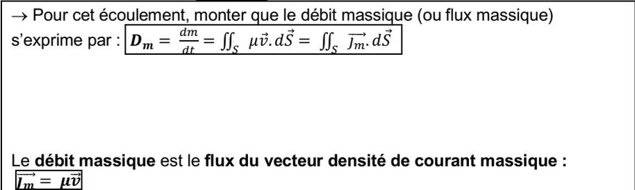
On retrouve une analogie formelle avec le transport par diffusion thermique et particulaire : le rôle des vecteurs densité de courant  $\vec{J}_Q$  et  $\vec{J}_N$  est ici tenu par le vecteur densité de courant de masse  $\vec{J}_m$  pour le transport de masse.
