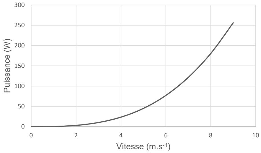
**Figure 13a** -  $P_T$  (W) en fonction de la vitesse  $v$ (m·s<sup>-1</sup>) pour le cycliste A
