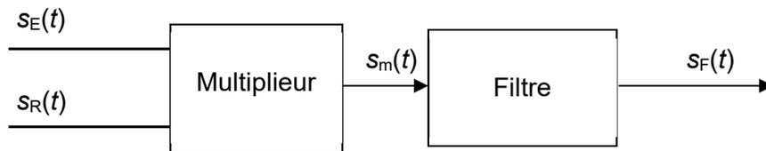
Figure 7 - Détection synchrone
