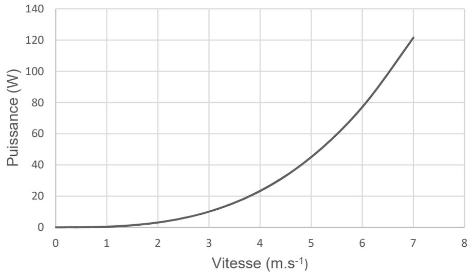
**Figure 13b** -  $P_T$  (W) en fonction de la vitesse  $v$ (m·s<sup>-1</sup>) pour le cycliste B
