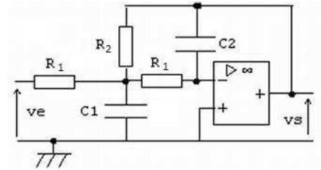
Pour déterminer la nature du filtre sans calcul, nous remplaçons dans le montage les condensateurs par leurs équivalents à basse et haute fréquence :
