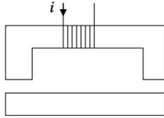
La section droite de l'électroaimant vaut  $S = a^2$  avec  $a = 2,0$  cm. La section droite au sein de la pièce à soulever vaut  $S_p \approx 2S$ .
