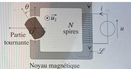
On choisit un modèle  $L(\theta)$  pour l'inductance du circuit magnétique, vue de la bobine :  $L(\theta) = L_1 + L_2 \cos(2\theta)$ .
