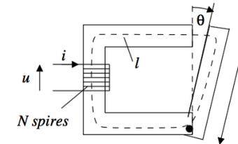
La longueur moyenne du matériau vaut  $l$  et sa section constante  $S$ . Il comporte une partie, de longueur  $a$ , mobile autour d'un axe perpendiculaire au plan de la figure.
