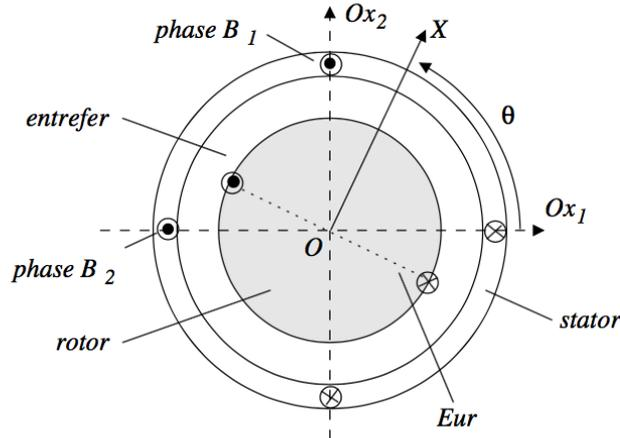
Son rotor porte un circuit inducteur (Eur) monophasé alimenté par le courant continu  $I_r$ . Le maximum de la mutuelle d'inductance entre (Eur) et une phase de ( $I_t$ ) est  $\hat{M}$ , l'inductance propre de (Eur) est  $L_r$ , celle d'une phase de ( $I_t$ ) est  $L_s$ . On note  $Ox_1$  et  $Ox_2$  les axes magnétiques des bobines ( $B_1$ ) et ( $B_2$ ) et  $OX$  l'axe de la bobine (Eur).
