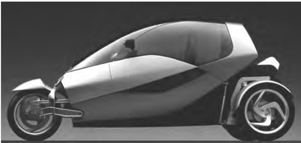
Le groupe motopropulseur est placé à l'arrière du véhicule. À l'avant, l'habitacle repose sur une roue de moto et pivote par rapport au bloc arrière autour d'une liaison pilotée angulairement par le biais de deux vérins hydrauliques. L'inclinaison est contrôlée par un ordinateur de bord en fonction de l'angle au volant et de la vitesse.
