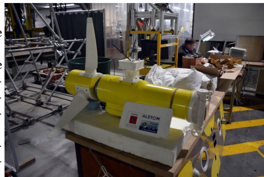
FIGURE 4 – Maquette de l'Hydrolienne testée par Alstom
