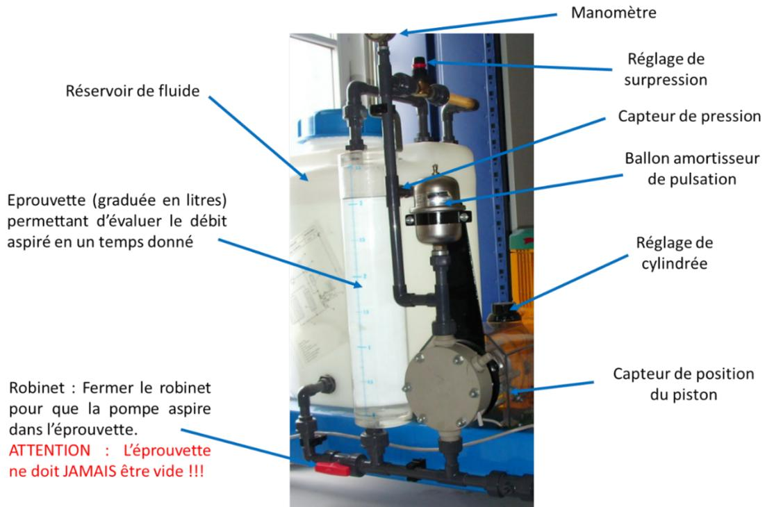
PRINCIPE DE FONCTIONNEMENT DU SYSTEME DE REGLAGE DU DEBIT
