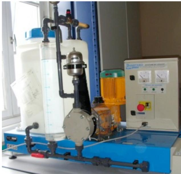
Le transfert de fluide est assuré par un doseur à membrane mu par un « piston » doté d'un mouvement de translation alternative. Le mouvement de base est fourni par un moteur électrique. La vitesse est réduite par un réducteur roue / vis sans fin. La rotation réduite est transformée en Translation alternative par l'intermédiaire d'un excentrique associé à la roue.
