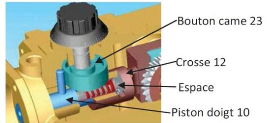
**La Crosse s'est avancée** suffisamment pour entrer en contact avec le piston, le piston est prêt à être poussé par la crosse.
