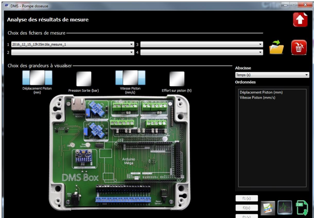
Sélectionner la ou les mesures à visualiser ainsi que les grandeurs en abscisse et en ordonnée. Cliquer sur le bouton figure en bas à droite pour visualiser les courbes.
