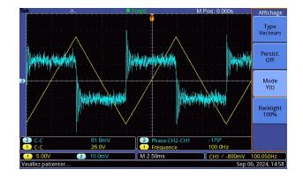
➤ Le signal de sortie est « bruité » : les harmoniques de rang élevé du signal d'entrée ne sont plus dans le domaine de fréquence pour lequel le filtre effectue une dérivation. On n'obtient donc pas exactement la dérivée du signal d'entrée. TP de physique nº 1 Solution
