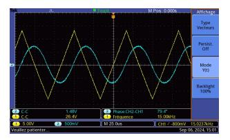
Attention : le signal de sortie ressemble à une sinusoïde, mais ce n'en est pas une!
