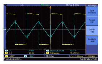
Si l'on prend un signal d'entrée triangulaire, on obtient le résultat suivant :
