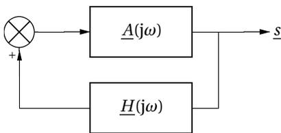
chaîne directe amplificateur de gain  $\underline{A}(j\omega)$
