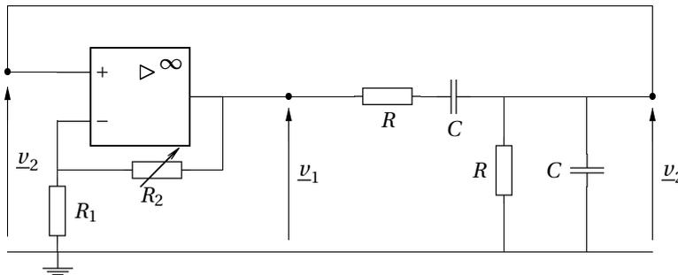
La chaîne directe est un amplificateur non inverseur de gain  $G = 1 + \frac{R_2}{R_1}$ .
