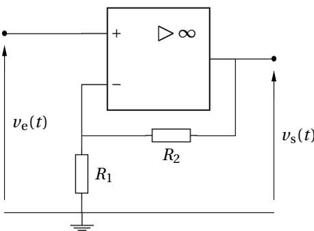
Déterminer le gain  $G_0$  de ce circuit lorsque l'ALI est en fonctionnement linéaire. Quelle est la condition sur la tension d'entrée pour qu'il en soit ainsi?
