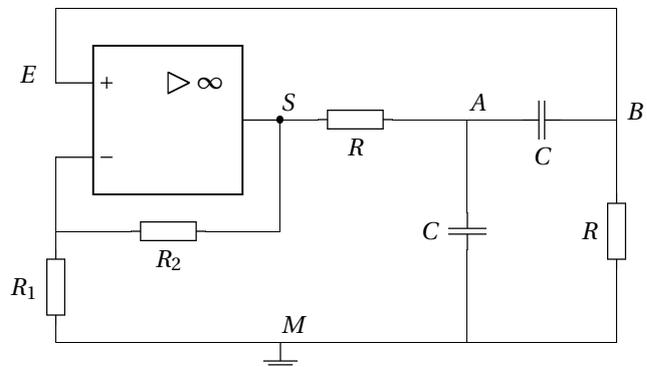
L'ALI est idéal, avec  $V_{sat} = 15$  V. On donne  $R = 1$  k $\Omega$  et  $C = 1$   $\mu$ F.
