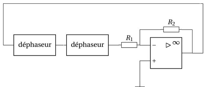
Montrer que ce circuit bouclé peut donner naissance à des oscillations pour une certaine valeur de  $R_2$ , la valeur de  $R_1$  étant fixée. Déterminer la fréquence des oscillations.
