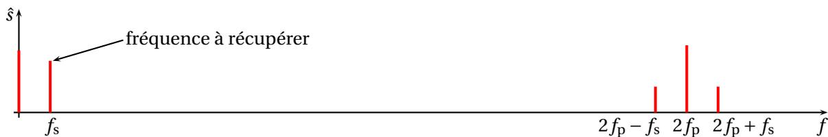
On retrouve la fréquence du signal à l'aide d'un filtre passe-bas<sup>2</sup> de fréquence  $f_c$  avec  $f_s < f_c \ll 2f_p$ .
