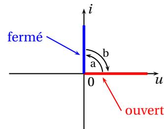
Le transistor est un interrupteur à **commutation commandée** à l'ouverture (blocage b) et à la fermeture (amorçage a).
