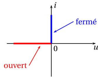
La diode est un interrupteur à **commutation spontanée** : le blocage se produit lorsque la tension  $u$  devient négative.
