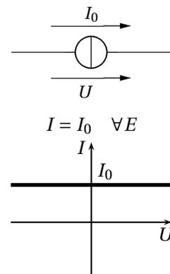
➤ Un interrupteur ouvert est une source de courant  $I_0 = 0$ .
