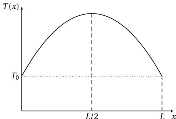
2. La température est maximale au milieu du fusible, en  $x = L/2$ . En cas de dépassement de  $I_{\text{max}}$ , la rupture se produit donc en  $x = L/2$ .
