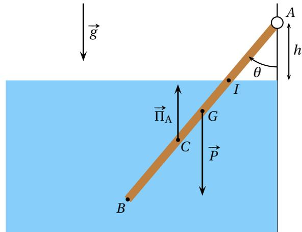
La tige étant homogène,  $G$  est au milieu de  $AB$  et  $C$  est au milieu de  $IB$ .
